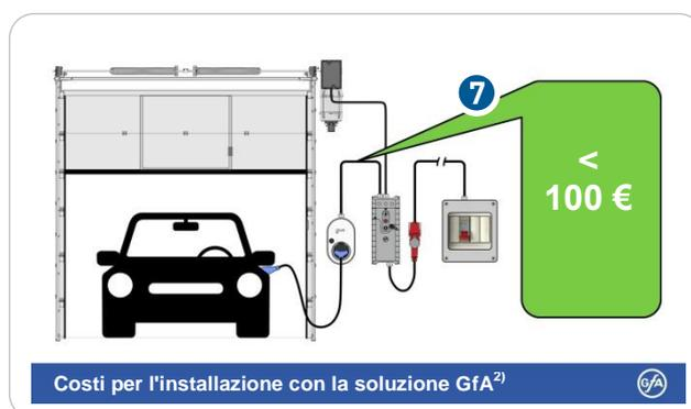
Un sistema di gestione della ricarica integrato consente di non superare la potenza massima assorbita di 11 kW anche in caso di movimento del portone (8). In questo modo, l'impianto non è soggetto ad autorizzazioni.<sup>3)</sup>
