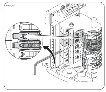
Il finecorsa APERTURA D'EMERGENZA S1 è preimpostato mediante la regolazione della posizione finale di APERTURA. In caso di errato senso di rotazione o di avaria del finecorsa di APERTURA S3 il portone deve essere arrestato senza alcun rischio. Se necessario, correggere il punto di commutazione del finecorsa mediante la regolazione di precisione.
