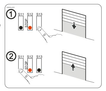
La posizione finale di APERTURA può essere corretta mediante la regolazione di precisione. Dopo una correzione controllare la posizione del portone.
