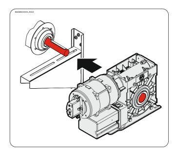
Serrare tutti gli elementi di collegamento (M12) a 75 Nm. Montare tutti gli altri elementi di collegamento in base alle indicazioni del produttore del portone.
