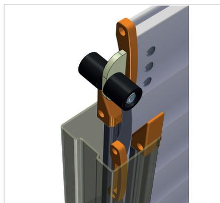
Lo scorrimento ottimale della staffa Rolling richiede una guida laterale con uno specifico profilo a "C" con guarnizioni termoplastiche, inviti in nylon e squadra di fissaggio montata in corrispondenza di ogni staffa.
